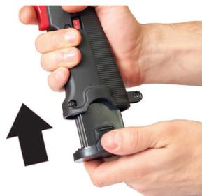
Для отсоединения аккумулятора: Отсоедините аккумулятор, нажав на фиксаторы с двух сторон (крепко держа рукоятку инструмента).
