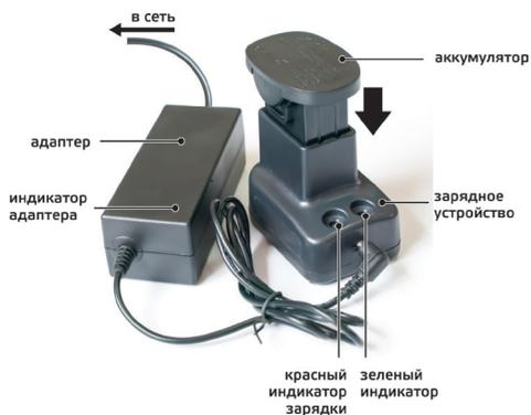
1. Полностью вставьте аккумулятор в зарядное устройство в соответствии со знаками анода и катода. Убедитесь, что аккумулятор плотно закреплен. Соедините адаптер с зарядным устройством и подключите к розетке с напряжением 110-240 В.
